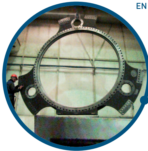
Couvercle puissance 5 MW 4 tonnes EN GJS 400-18U
